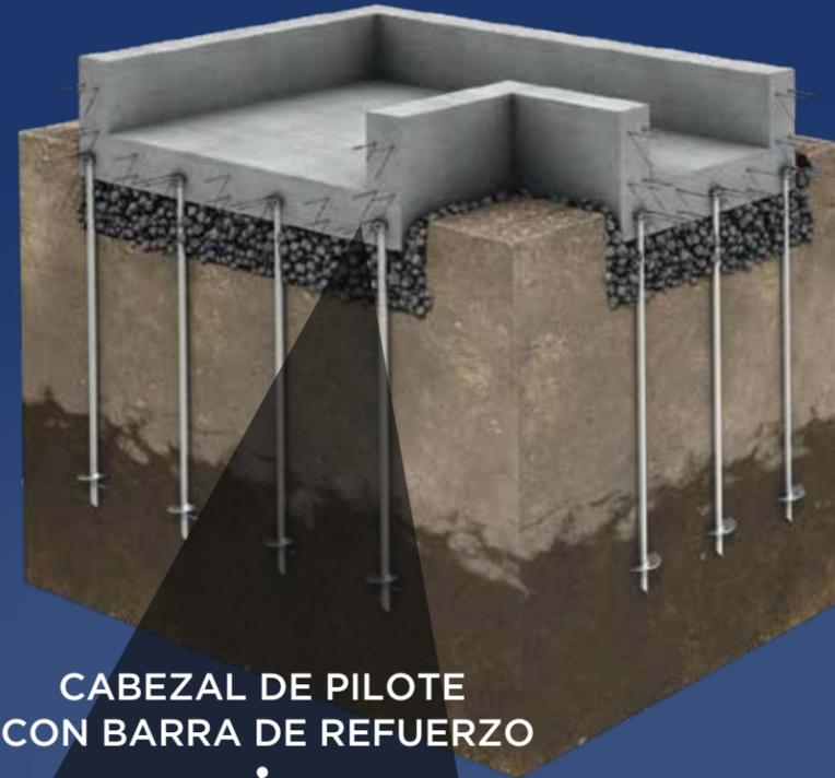
CABEZAL DE PILOTE CON BARRA DE REFUERZO
